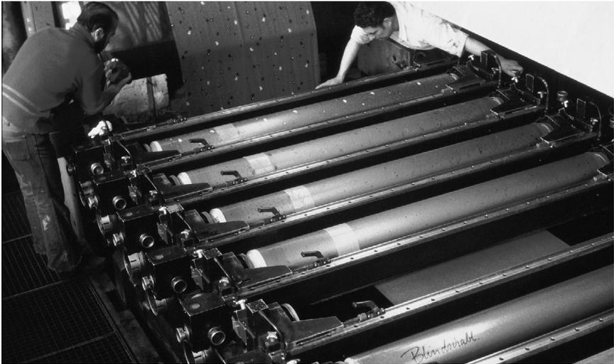
*Rotationsfilmdruckmaschine bei H. W. Küster. Deutlich sind die zylindrischen Druckschablonen zu erkennen. Hartmut Graupner, 1980*
